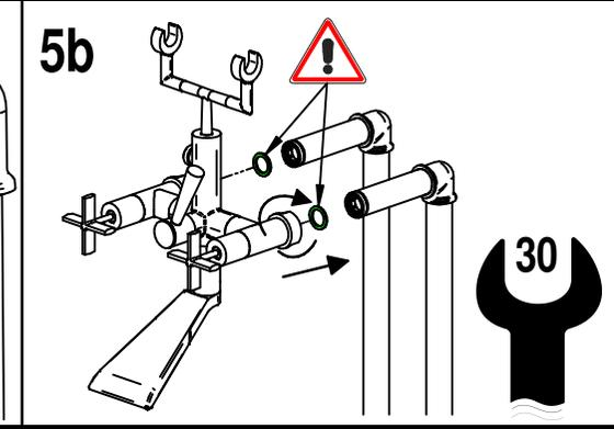
**SOSTITUZIONE VITONE / VALVE REPLACEMENT**
